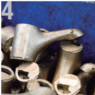
4 Extracción noyo arena Sand core pullers extraction Extraction des noyaux de sable
